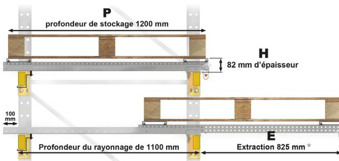
\* Extraction réduite à 800 mm en charge 1000 kg
