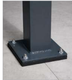
Calage standard : fixation par 4 chevilles béton à expansion, calage par interposition de platine d'épaisseur 2 ou 3 mm.
